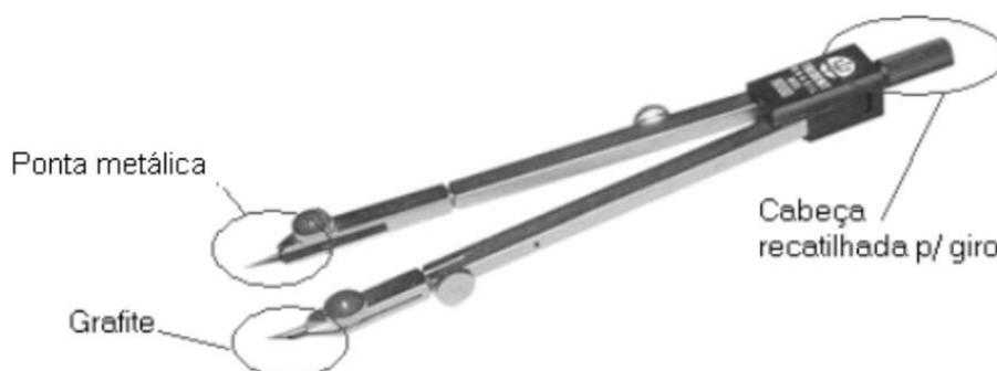
Figura 3.3 - Ilustração de um compasso.
