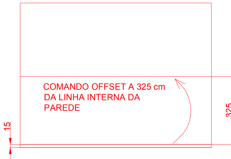
Figura 3.3- Utilização do DESLOCAMENTO para construção das paredes
