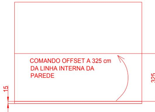
Utilização do offset para construção das paredes
